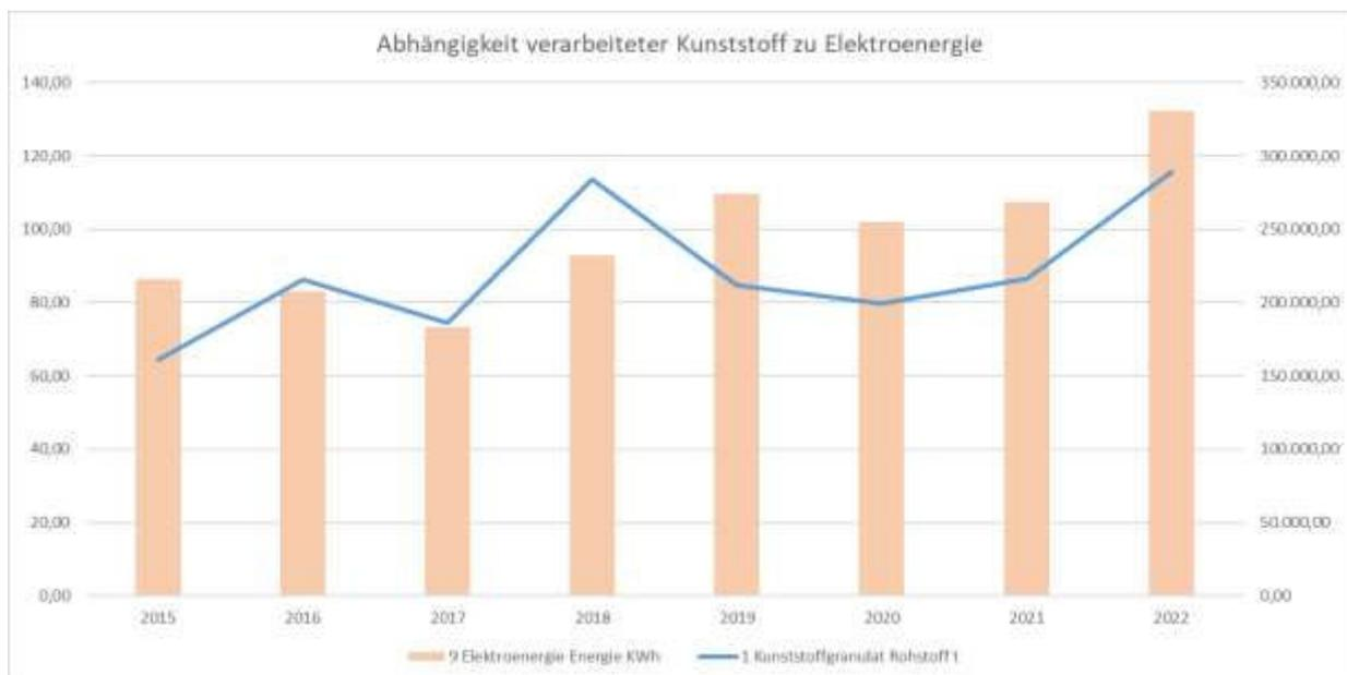
Der Energieverbrauch hängt in erster Linie vom Umfang und Inhalt der Produktionsaufträge ab. Aus dem Diagramm ist ersichtlich, dass der Energieverbrauch im Verhältnis zur Menge des verarbeiteten Granulats geringfügig gestiegen ist aufgrund der Verarbeitungstemperaturen der Granulate. Energieeinsparungen waren und sind nur
